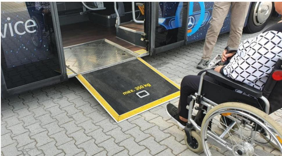
Beispiel ohne Bordsteinerhöhung: Einsatz einer Rollstuhl-Klapprampe in Kombination mit absenkbarem Niederflerbus inkl. Kneeling
