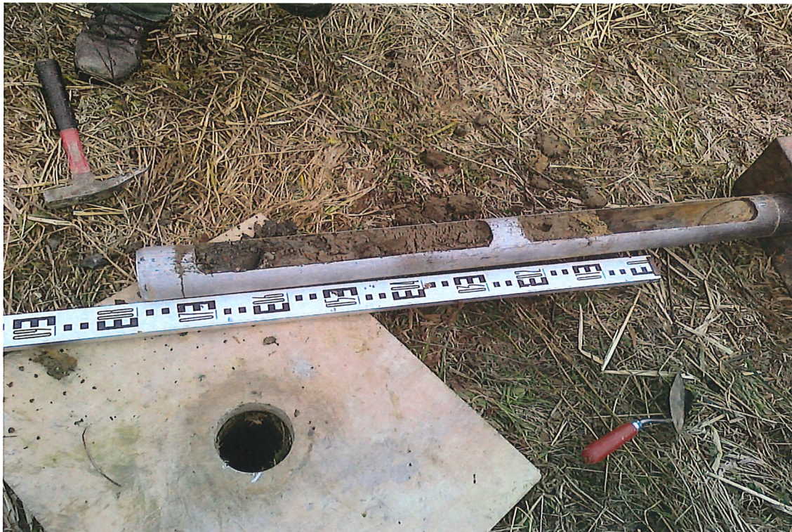
Bohrsondierung BS 2, 0-1 m
