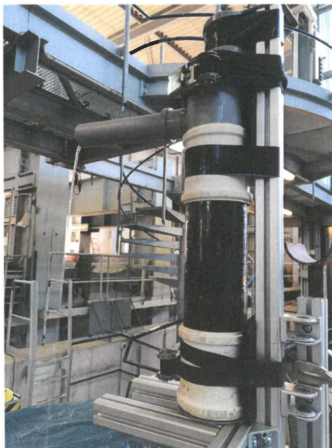
Bild 5: Aufgebaute Säule während der Schwermetallprüfung und der Standzeitermittlung.
