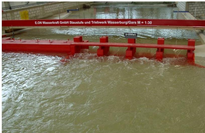
**Abb. 3:** Modellversuch zur hydraulischen Grundlagenermittlung (KW in Blockbauweise)
