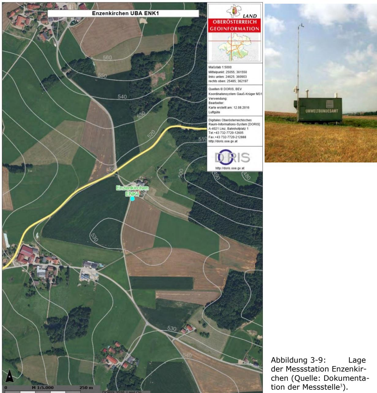
An dieser Hintergrundmessstelle werden SO<sub>2</sub>, Feinstäube, Stickoxide, Ozon und meteorologische Größen erfasst. Die in Österreich verwendeten Messsysteme und die Qualitätssicherung sind im Bericht Luftgütemessungen und meteorologische Messungen<sup>4</sup> dokumentiert.
