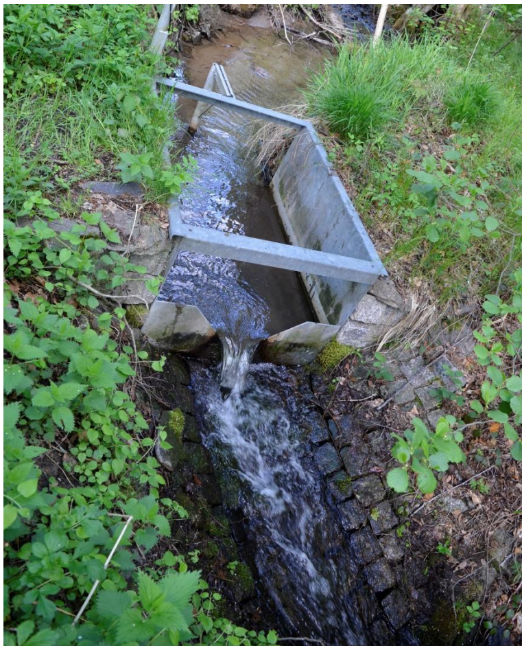
Abbildung 44: Thomson Wehr zur Abflussmessung im Bereich der 3. Strecke.
