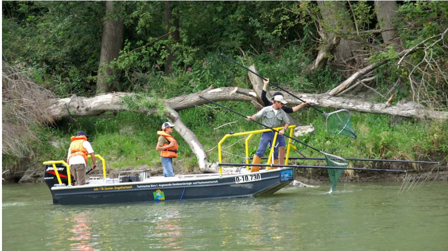
Abbildung 8: Elektrofischerei mit dem Großen Aluboot und Anodenrechen (Foto: Donau-Nebenarm Pritzenau, Wachau)
