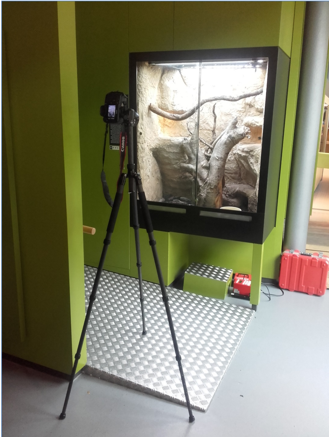
Abbildung 9: Geräteanordnung bei der Verhaltensdokumentation (unter dem Terrarium ist der rote Erschütterungssensor erkennbar)
