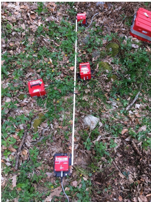
Abbildung 17: Anordnung des Versuchsaufbaus zur Schwingungsmessung im Wald an den Donauleiten (mit Gneiszersatz als Untergrund) (links: 0,2/1/2m; rechts: 0,2/2/4m)
