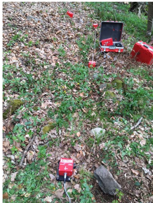
Abbildung 17: Anordnung des Versuchsaufbaus zur Schwingungsmessung im Wald an den Donauleiten (mit Gneiszersatz als Untergrund) (links: 0,2/1/2m; rechts: 0,2/2/4m)
