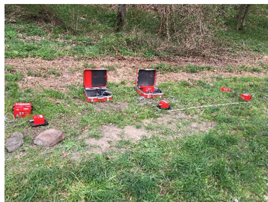
Abbildung 16: Anordnung des Versuchsaufbaus zur Schwingungsmessung auf der Wiese mit sandigem Untergrund am Waldrand (links: 0,2/1/2m; rechts: 0,2/2/4m)
