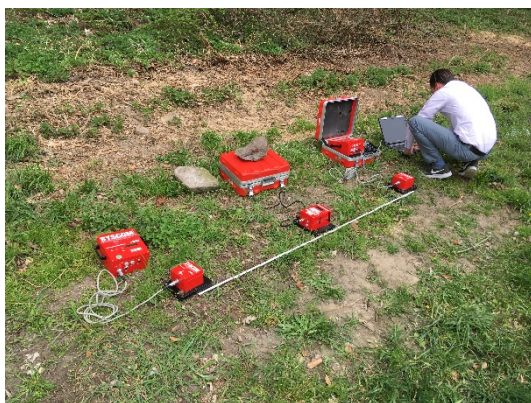
Abbildung 16: Anordnung des Versuchsaufbaus zur Schwingungsmessung auf der Wiese mit sandigem Untergrund am Waldrand (links: 0,2/1/2m; rechts: 0,2/2/4m)
