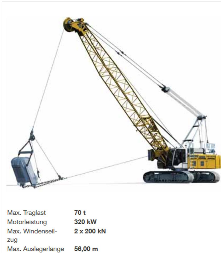
Abbildung 31: Exemplarisches Beispiel Seilbagger Liebherr HS 8070
