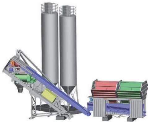
Abb. 2 Anlagenkonzept containermobile Betonanlagen
