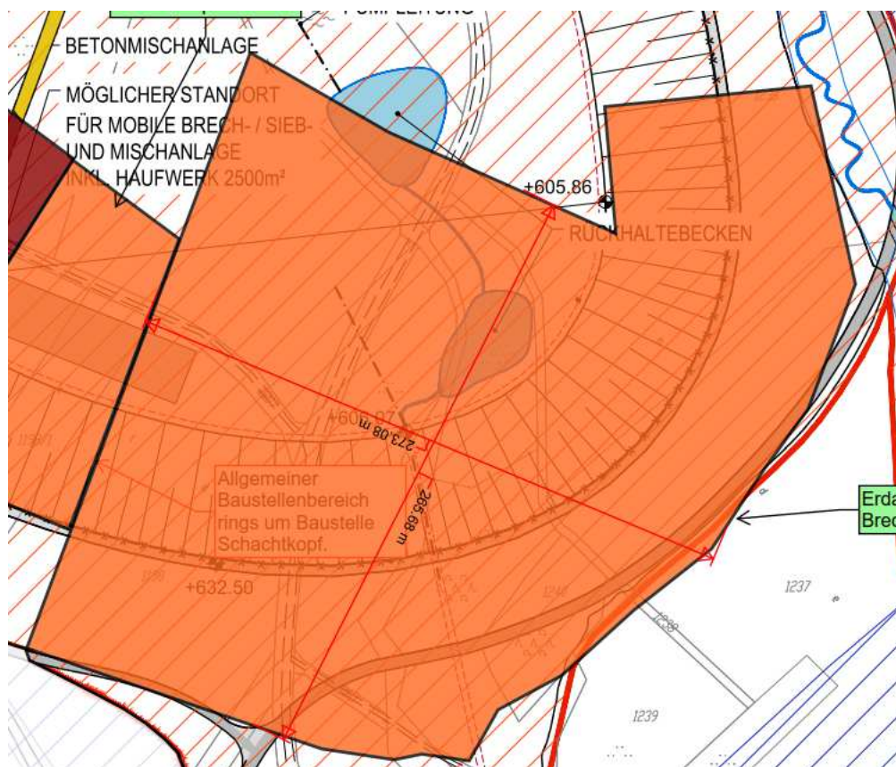
Abbildung 43: Planauszug Beispiel Baufeld Erdarbeiten ESR Speichersee
