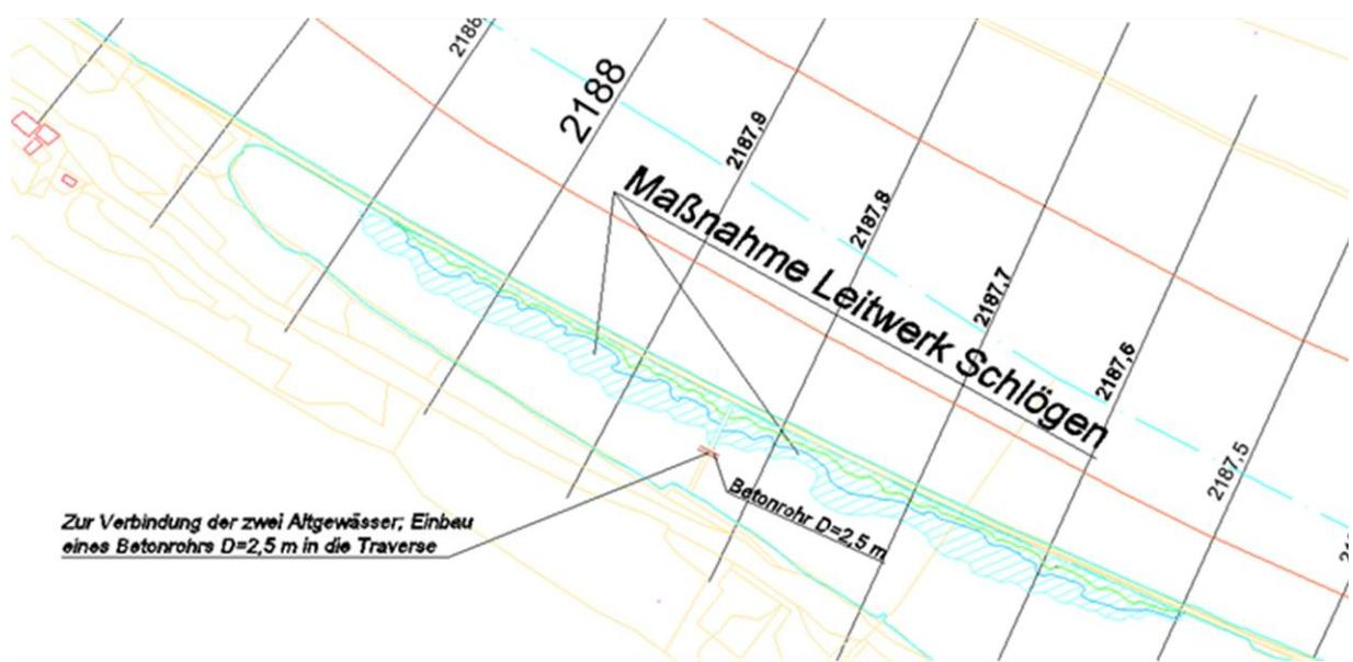
Abbildung 18: Übersicht der geplanten Maßnahme im Bereich Leitwerk Schlögen (blau schraffiert) inkl. Maßnahme "Durchgängigkeitsgestaltung Altwässer"
