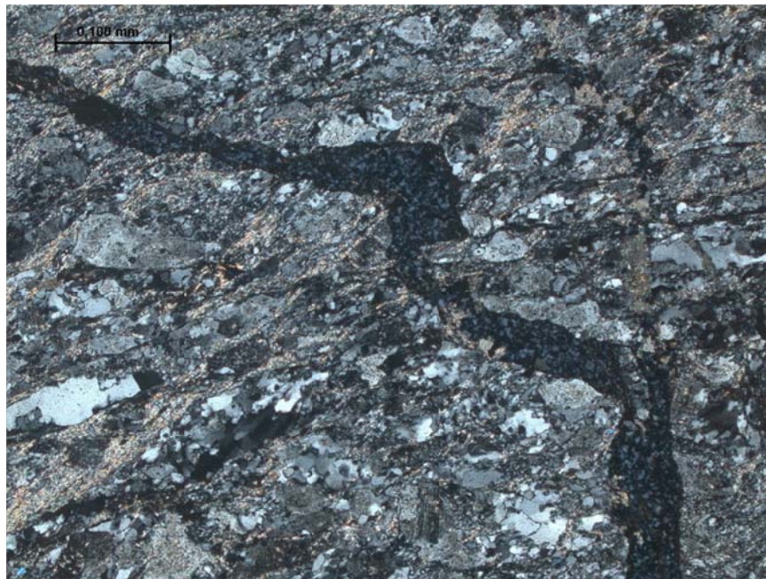
Probe 13300: Sekundäre Chloritader schneidet metamorphe Foliation, gekreuzte Polarisatoren.
