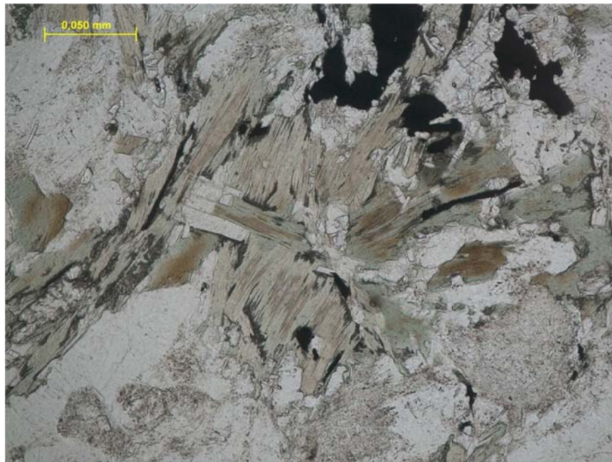
Probe 13298: In-Situ Chloritisierung von Biotit führt zu feinkörnigen Ausfällungsprodukten (Kornrand) und Erzausfällungen, parallele Polarisatoren.
