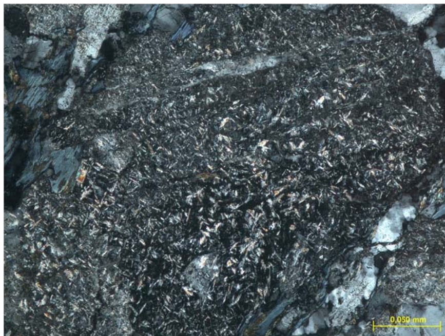
Probe 13298: Sericitisierung eines Felspatkorns, gekreuzte Polarisatoren.
