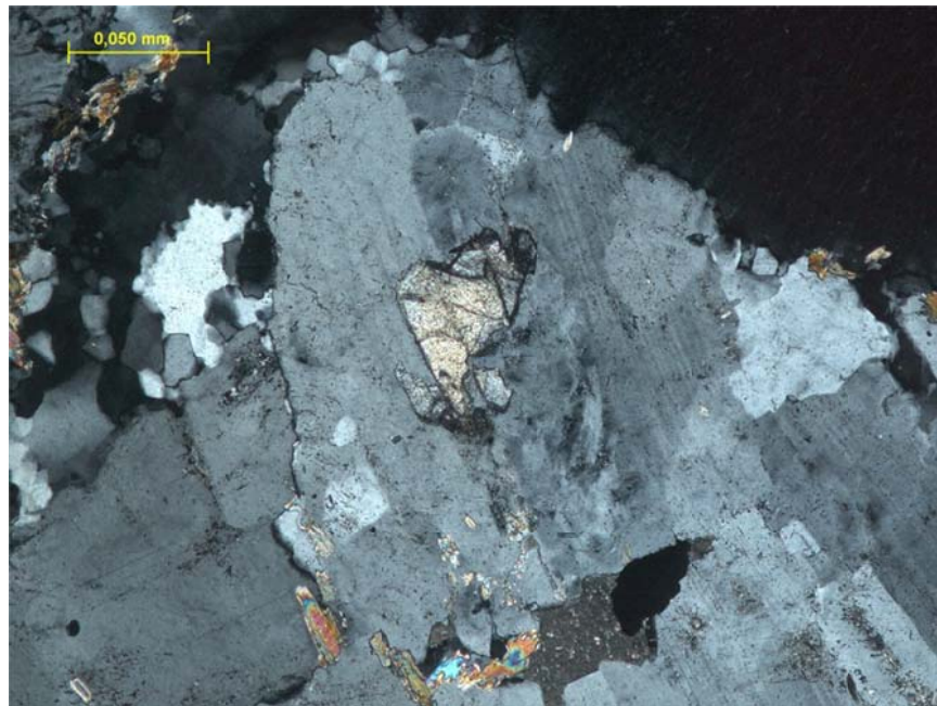
Probe 13299: Klinozoisiteinschluss in Kalifeldspat, gekreuzte Polarisatoren.
