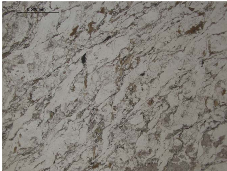
Probe 13298: Textur der Probe zeigt metamorphe Foliation, parallele Polarisatoren.
