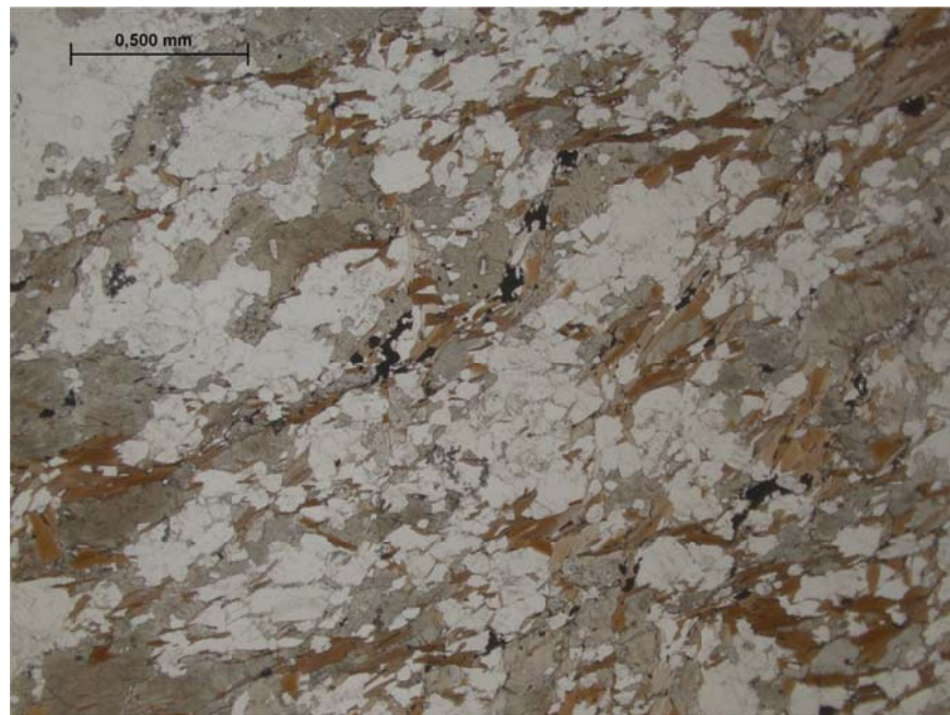
Probe 13301: Die Textur der Probe zeigt eine mittelmäßige ausgeprägte Foliation, parallele Polarisatoren.
