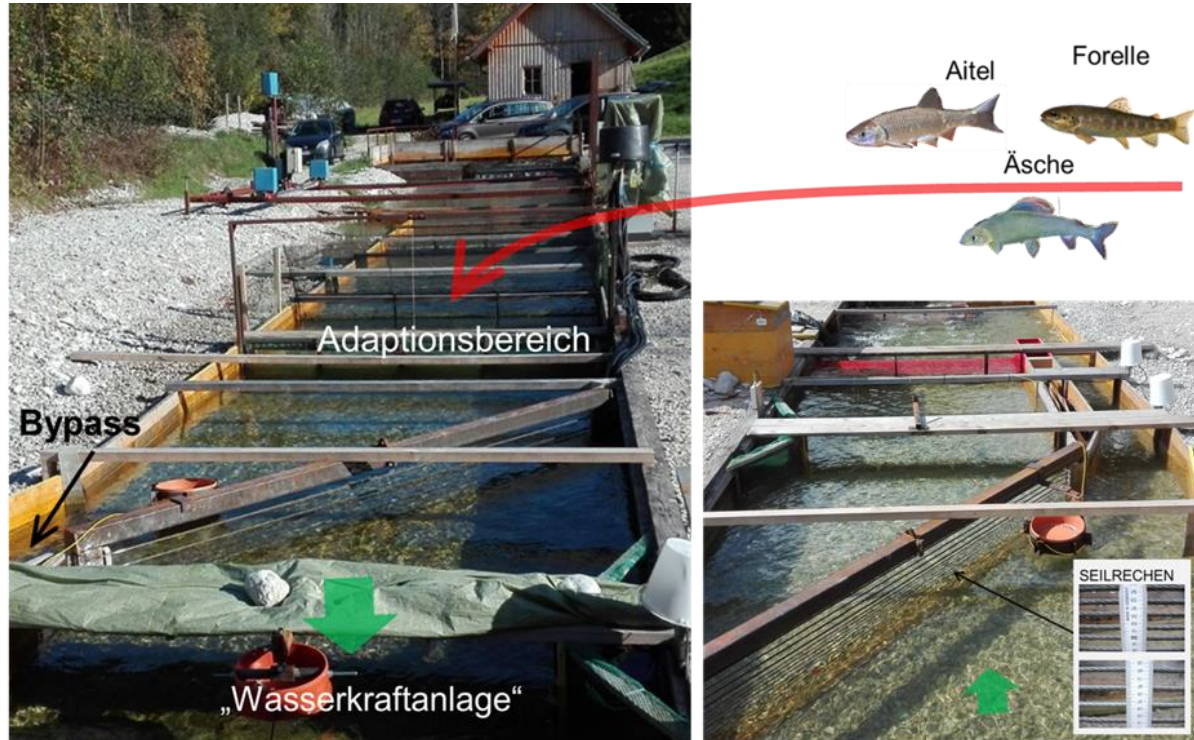
Abbildung 2: Layout der Versuchsanlage in Lunz am See und verwendete Fischarten
