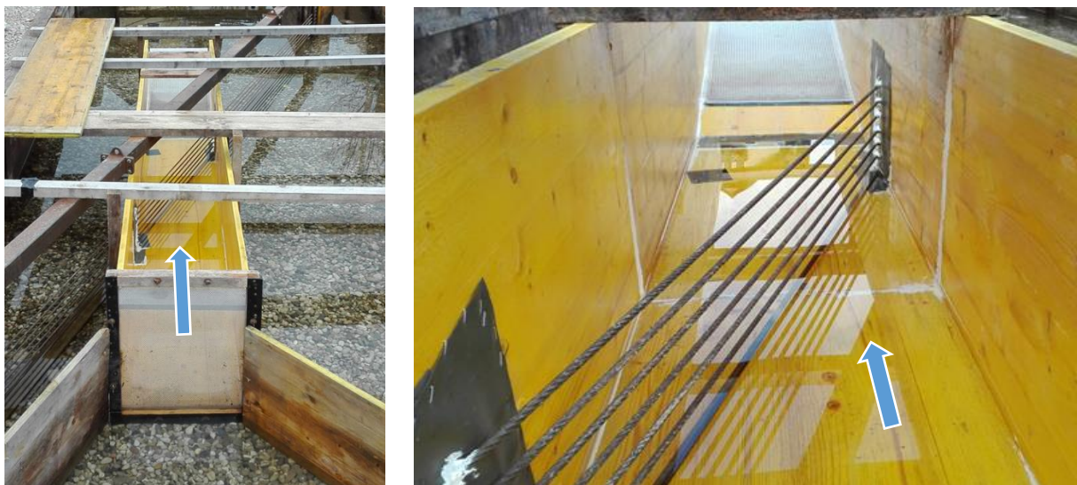
Abbildung 9: Für die Driftversuche umgesetztes Versuchssetup in Lunz am See mit Fließrichtung
