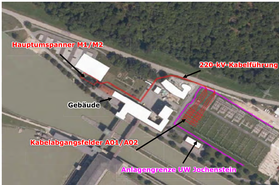
Abbildung 2: Energiespeicher Riedl – geplante elektrische Anlagenteile
