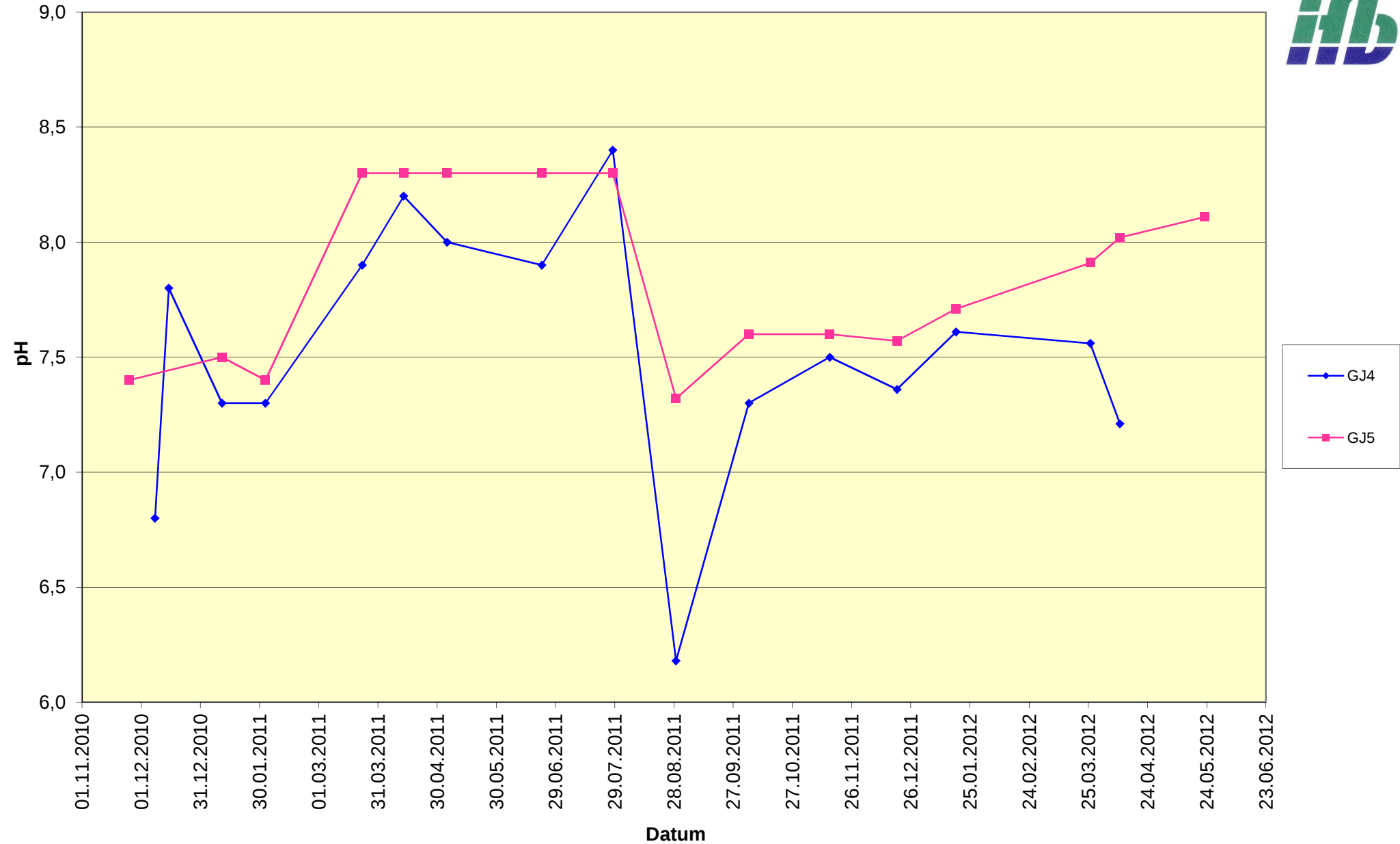
pH-Wert in den Messstellen der WV Jochenstein (vgl. Lageplan Anlage 1.3.7)
