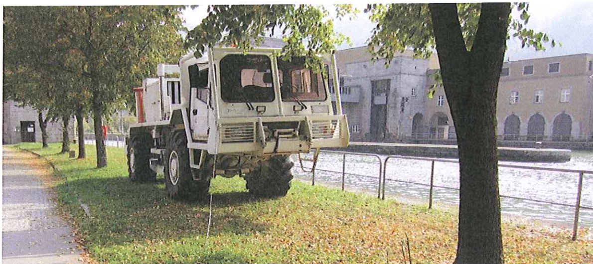
Abbildung 1 VibroScan.at Schwingungsgenerator vor dem Kraftwerk Jochenstein
