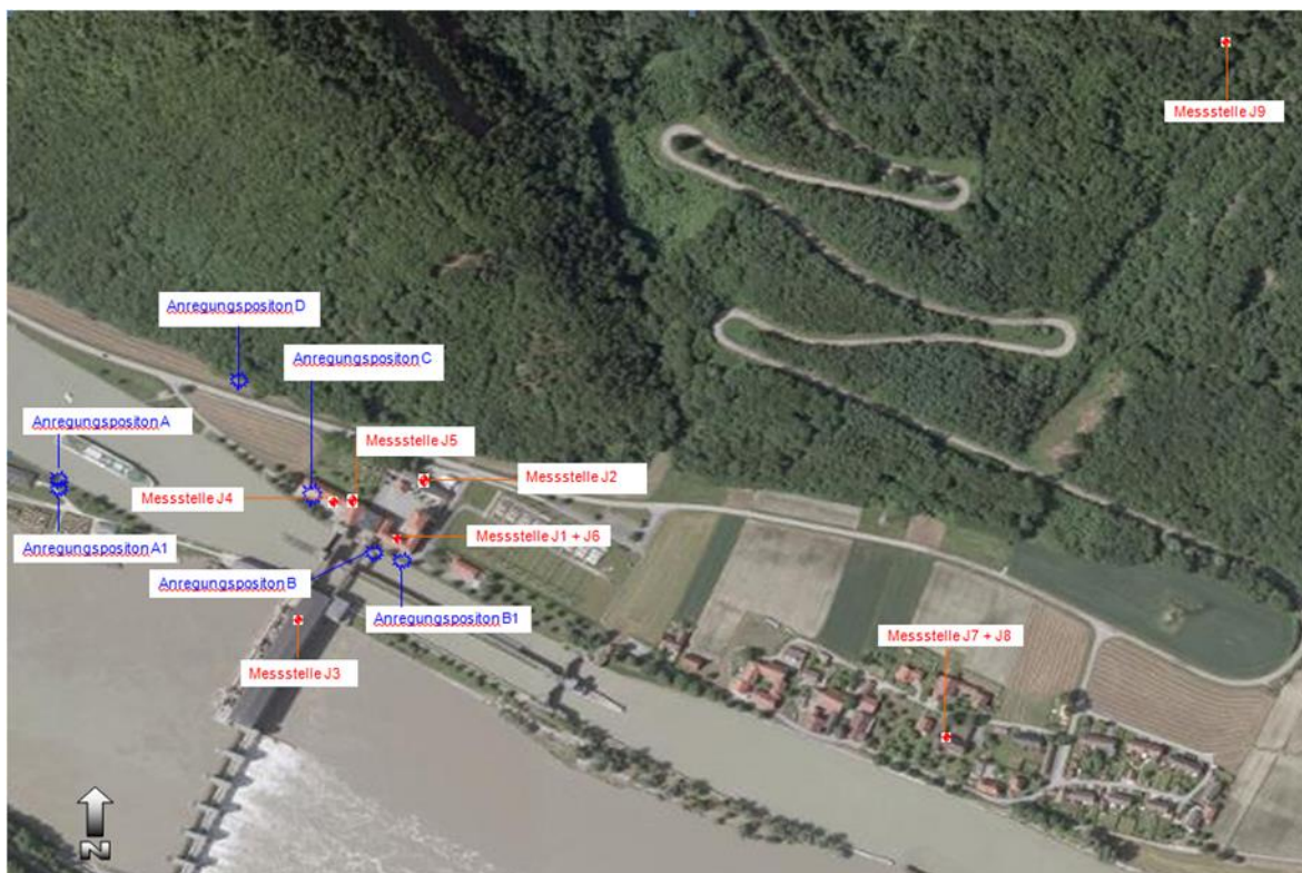
Abbildung 5: Messpunkte der Erschütterungsmessungen in Jochenstein mit Anregungspunkten durch den Vibroscan. J2 ist eine Fundamentmessstelle im Haus am Strom.
