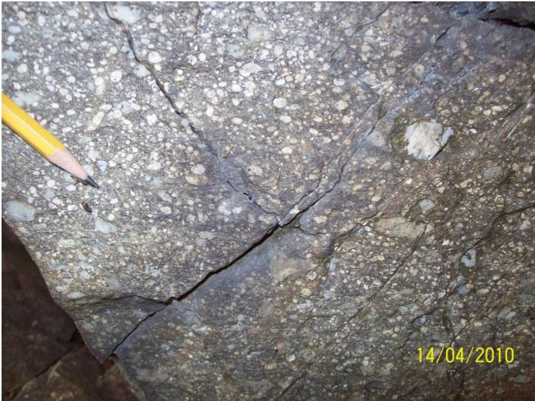
Abbildung 8.5: mylonit. Granitgneis, Aufschlusspunkt 75a
