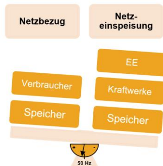
Abbildung 4-26 Stabilisierung der Netzfrequenz durch Regelreserve
