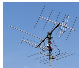
Abb. 71: Amateurfunkantenne (X-Quad für 70-cm- und 2-m-Band, 1,7-GHz-Yagi und UKW-Antenne).
