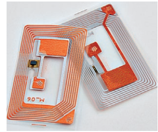
Abb. 73: Innenleben einer RFID-Card.
