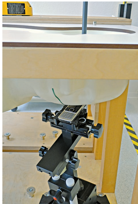
Abb. 89: Messung des SAR-Werts eines Handys: Die Messsonde (schwarz) am Roboterarm (orange) ermittelt im flüssigkeitsgefüllten SAM-Phantom (weiß) den Ort der höchsten Feldstärke.
