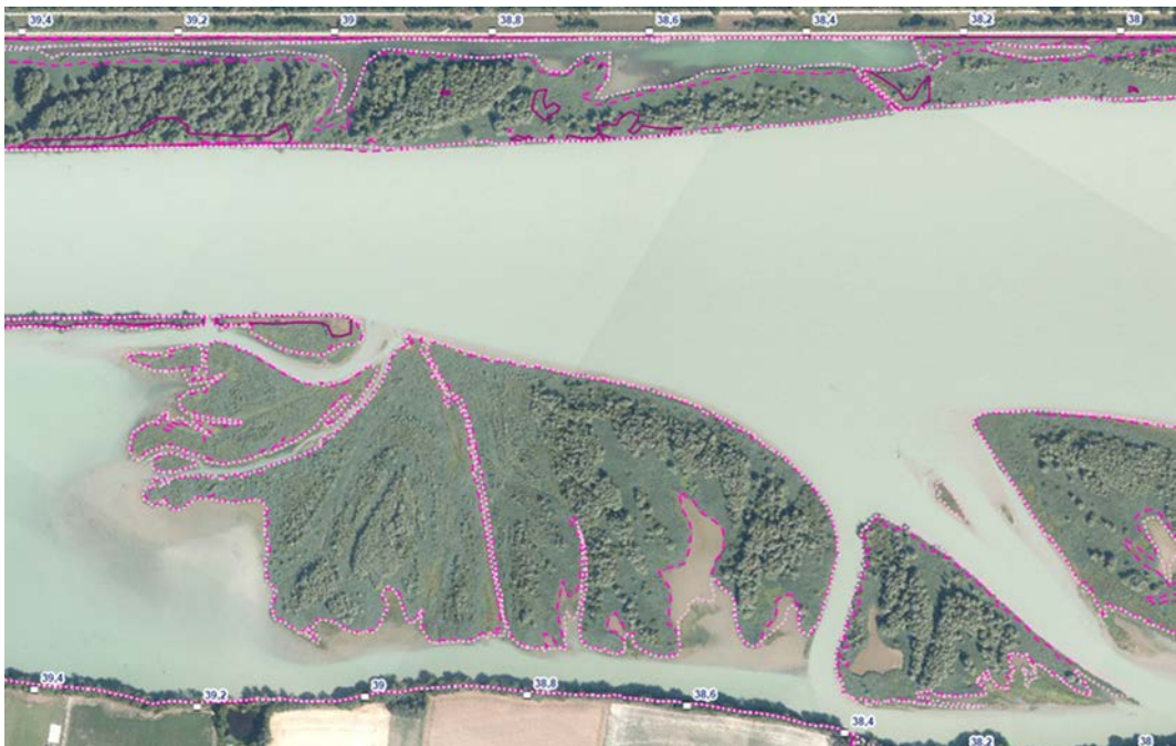
Abbildung 29: Anschlagslinien Bestand NQ, MQ, MHQ im Bereich ca. Fl.km 38,2 bis 39,4 (Legende s. Abb. 116)
