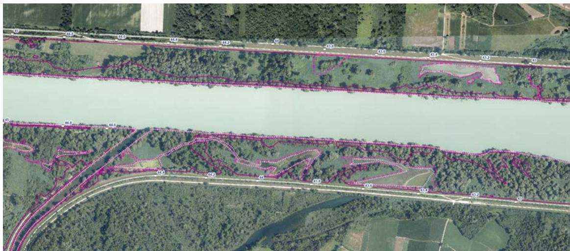
Abbildung 30: Anschlaglinien Bestand NQ, MQ, MHQ im Bereich ca. Fl.km 43,0/45,0 (Legende s. Abb. 116)
