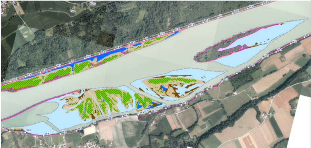
Abbildung 40: Situation im Bereich der Inseln im Oberwasser des Kraftwerks / Kirchdorfer Bucht bei MHQ – 2,0 m
