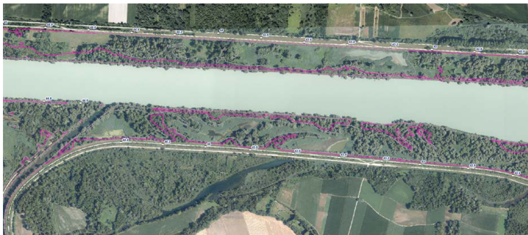
Abbildung 37: Anschlaglinien Bestand MHQ sowie MHQ – 2,0 m im Bereich ca. Fl.km 43,0/45,0 (Legende s. Abb. 36)
