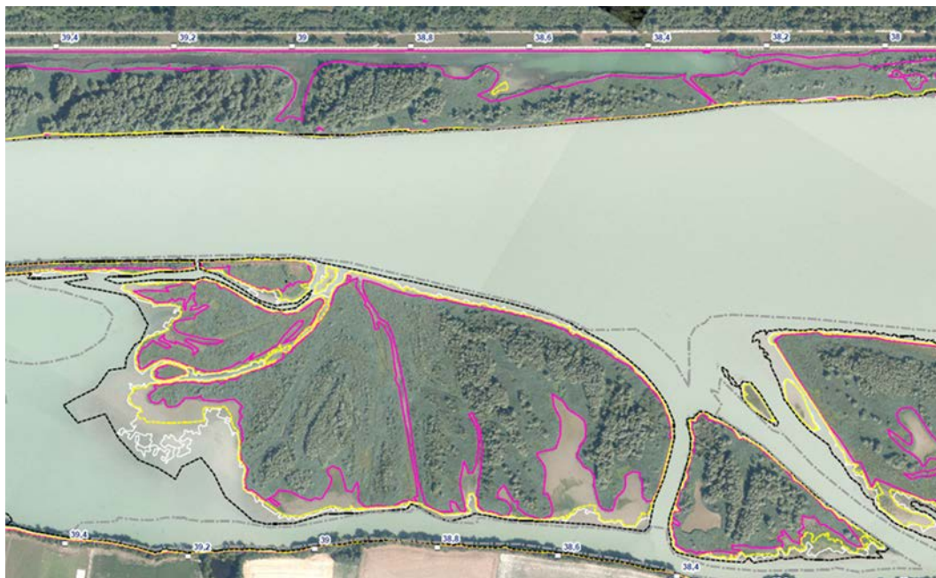
Abbildung 33: Anschlaglinien Bestand MQ, MQ – 0,25 m, MQ – 0,5 m, MQ – 1,0 m, MQ – 2,0 m im Bereich ca. Fl.km 38,2 bis 39,4 (Legende s. Abb. 32)
