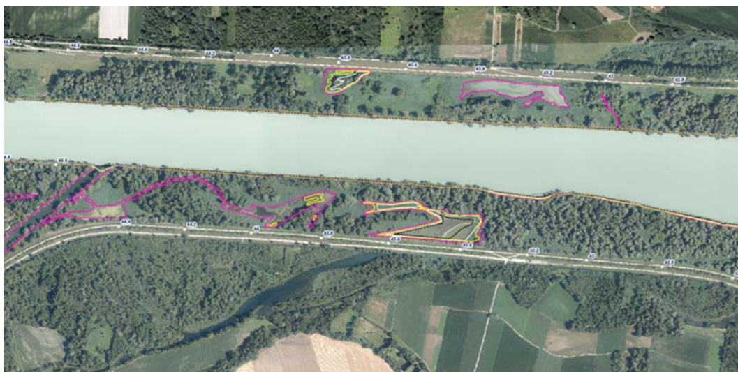
Abbildung 34: Anschlaglinien Bestand MQ, MQ – 0,25m, MQ – 0,5 m, MQ – 1,0 m, MQ – 2,0 m im Bereich ca. Fl.km 43,0/45,0 (Legende s. Abb. 32)
