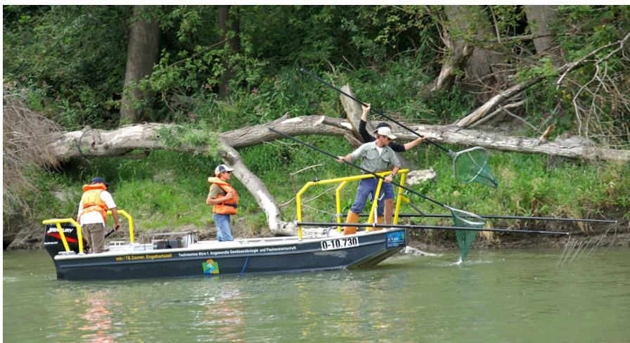
Abbildung 2: Elektrofischung mit dem großen Aluboot und Anodenrechen.
