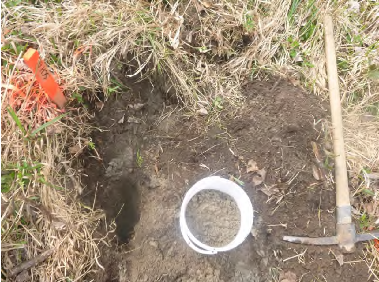
Abb. 7: Handschurf SCH6 (10.04.2019), die Beprobung im tieferen Abschnitt erfolgte mittels Bohrstock
